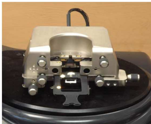
38 pav. Zondų laikiklio montavimas į mikroskopo galvą
