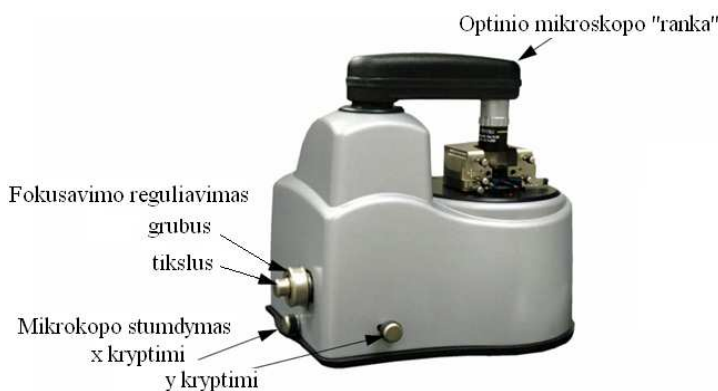
40 pav. SPM įmontuotas optinis mikroskopas, bei jo reguliavimo rankenėlės
