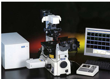
21 pav. Histologinių pjūvių ir ląstelių fluorescencijos vaizdų registravimo aparatūros schema.
