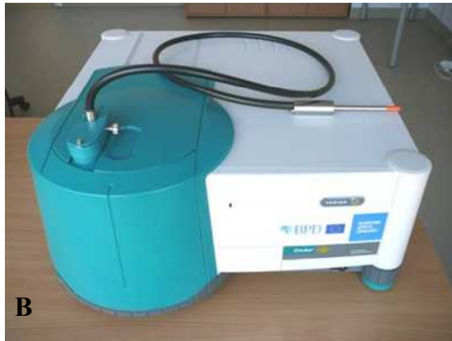
16 pav. Cary eclipse spektrofotometras su šviesolaidiniu priedu. A – bandinių skyrelyje įmontuotas šviesolaidinis priedas. B – pakeistas spektrometro viršutinis dangtis ir jame įtvirtintas šviesolaidis.
