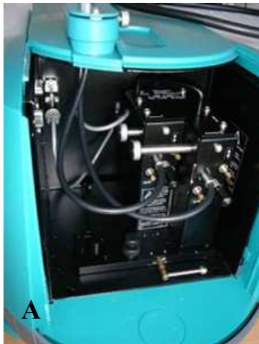
16 pav. Cary eclipse spektrofotometras su šviesolaidiniu priedu. A – bandinių skyrelyje įmontuotas šviesolaidinis priedas. B – pakeistas spektrometro viršutinis dangtis ir jame įtvirtintas šviesolaidis.
