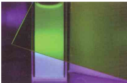
5.9 pav. Pastatius išsklaidytos žadinimo šviesos nepraleidžiantį filtrą, vėl matoma žalia tirpalo fluorescencija
